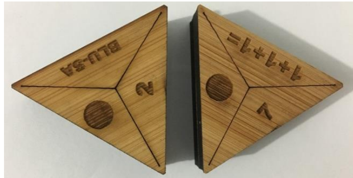
Figura 12 - Peça após o corte a laser
