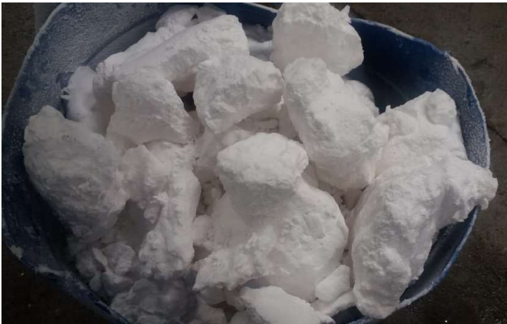
Figura 9 - Silicato de Sódio compactado após embalo quente.
