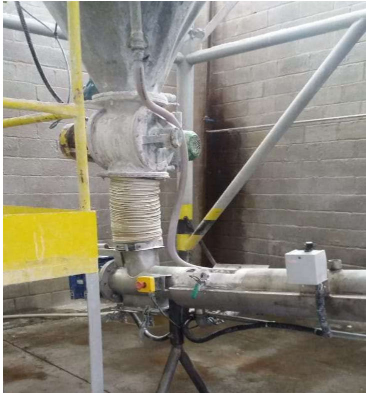
Figura 7 - Ligação entre Spray-Dryer e rosca sem fim na empresa UnaProsil.
