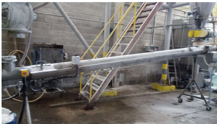
Figura 12 - Conjunto de spray-dryer com o trocador de calor tipo rosca sem fim na empresa UnaProsil. Fonte: Do autor.
