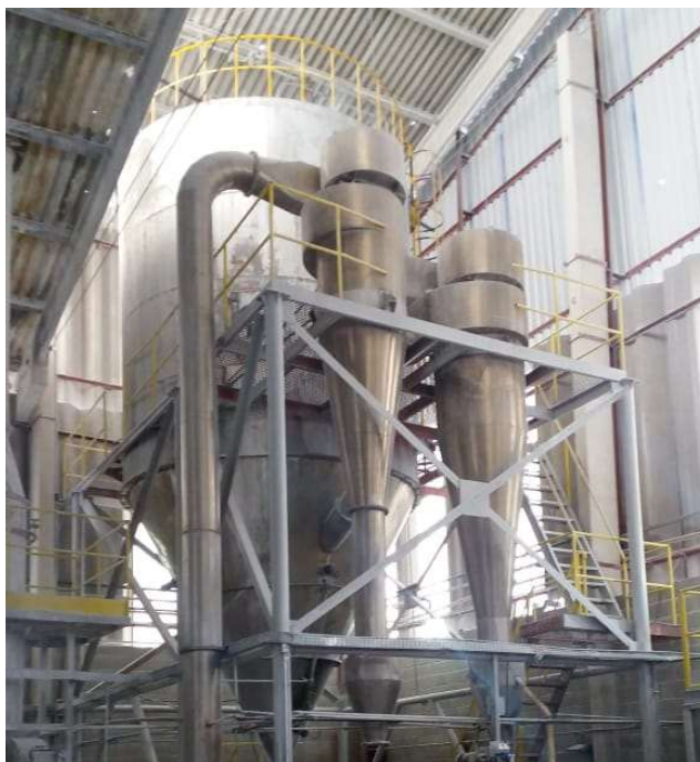
Figura 3 - Spray-dryer modelo LPG 400 da marca SunCheer na empresa UnaProsil.
