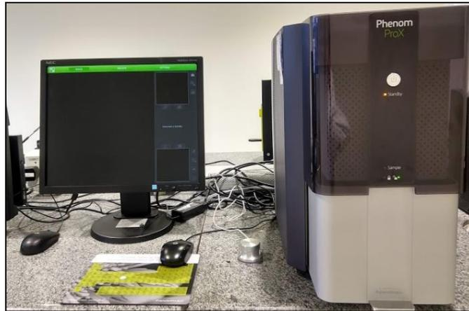
Figura 9: – Equipamento MEV - Microscopia eletrônica de varredura
