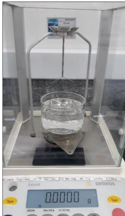
Figura 10: Balança de densidade pelo método Arquimedes.
