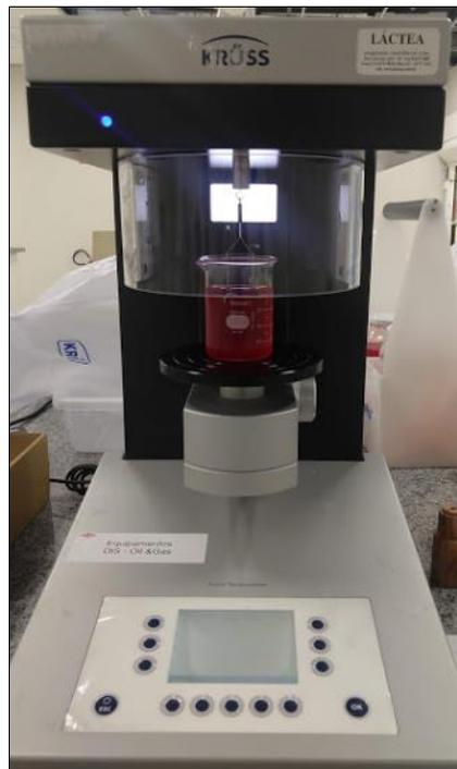
Figura 6: Tensiômetro de Du Nouy.
