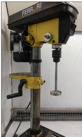
Figura 7: Agitador Ferrari de 3000 RPM para mistura do Polioli e isocianato.
