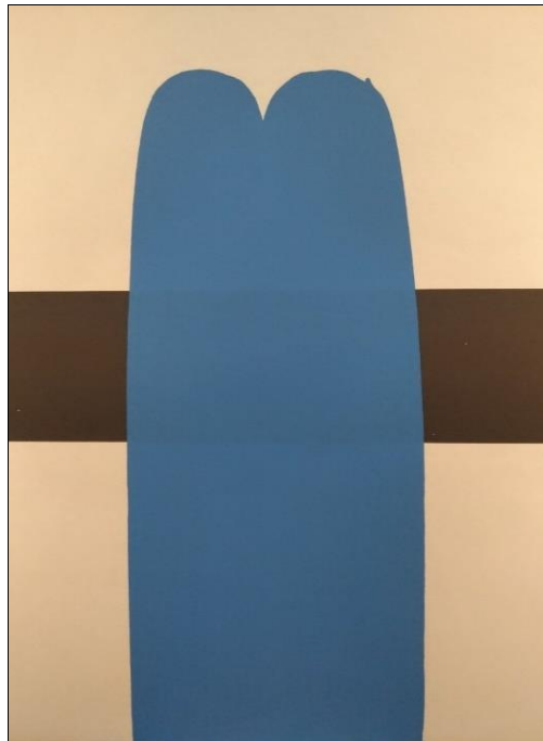
Figura 11: Determinação de poder de tingimento em papel tarjado.
