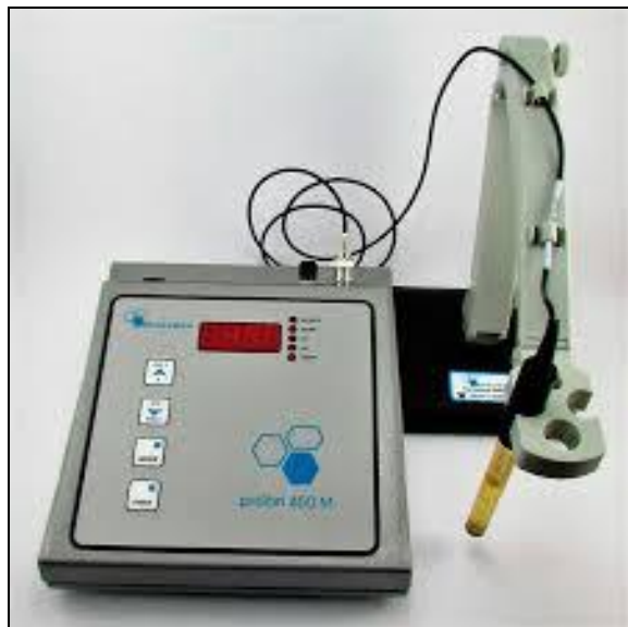
Figura 9: pHmetro de bancada.
