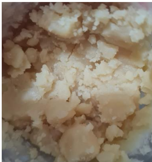
Figura 10 - Incompatibilidade química, formação de grumos (Cera de carnaúba com óleo mineral). Fonte: Próprios autores.
