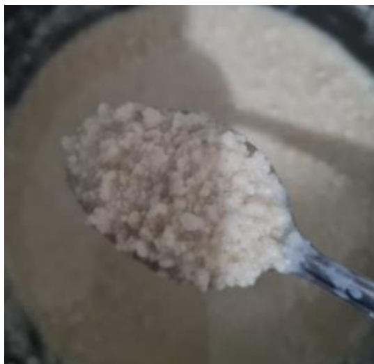
Figura 8 - Falha na homogeneização, polaridade: separação de fases (Cera de abelha com thinner). Fonte: Próprios autores
