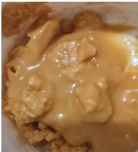
Figura 9 - Resultado após o excesso de temperatura no processo (Cera de carnaúba com óleo de linhaça). Fonte: Próprios autores.
