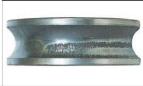
Figura 2 Escamamento. Fonte: (NSK BEARING DOCTOR, 2001).
