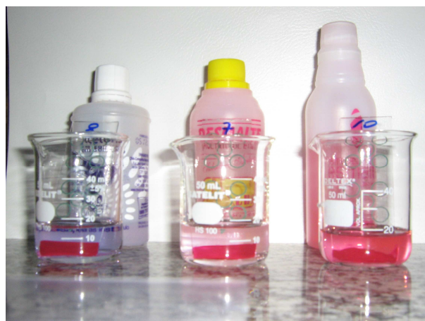
Figura 3: Teste de remoção de esmalte aderido às lâminas de vidro para definição do padrão de referência de eficácia do produto inovador.
