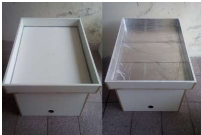
Figura 3- Protótipos antes e depois da manta asfáltica.
