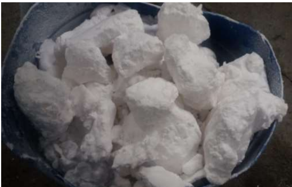
Figura 9 - Silicato de Sódio compactado após embalo quente.
