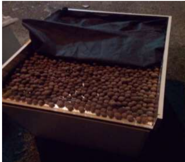
Figura 4 – Protótipo com argila expandida e manta geotêxtil.
