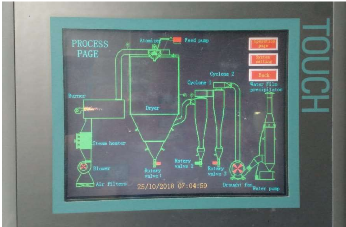
Figura 6 - Painel de funcionamento do Spray-Dryer da empresa UnaProsil.
