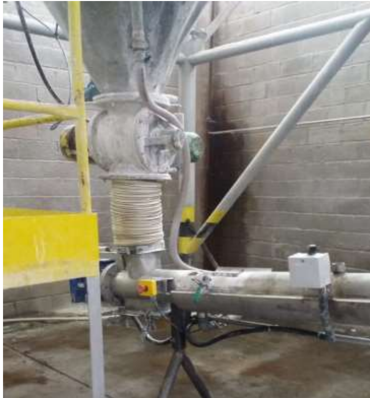
Figura 7 - Ligeira conexão entre Spray-Dryer e rosca sem fim na empresa UnaProsil.
