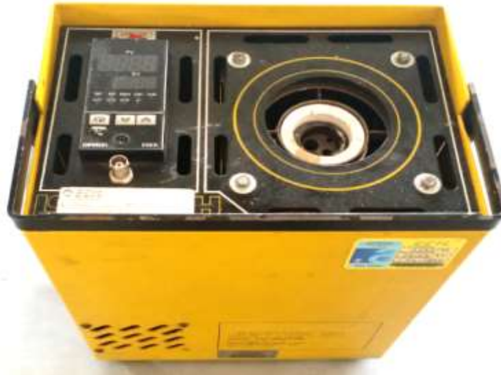
Figura 9 - Forno Júpiter utilizado para calibrar o sensor NTC
