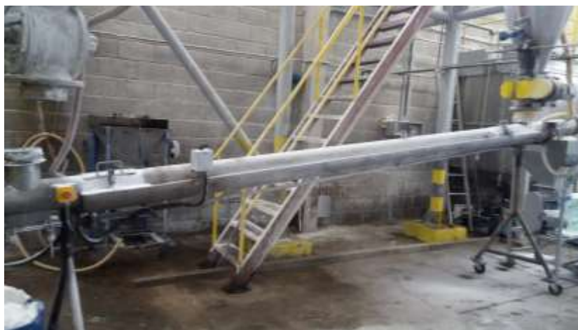
Figura 11 - Conjunto de spray-dryer com o trocador de calor tipo rosca sem fim na empresa UnaProsil. Fonte: Do autor.
