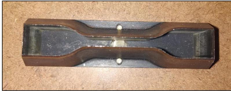
Figura 3: Molde para corpos de prova do dinamômetro.
