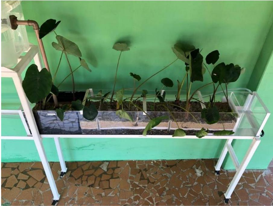
Figura 2. Protótipo jardim filtrante finalizado.
