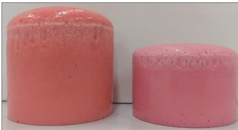
Figura 8: Espuma de poliuretano elastomérica microcelular de baixa densidade (esquerda) e de alta densidade (direita).
