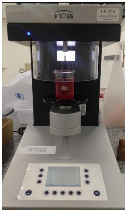
Figura 6: Tensiômetro de Du Nouy.
