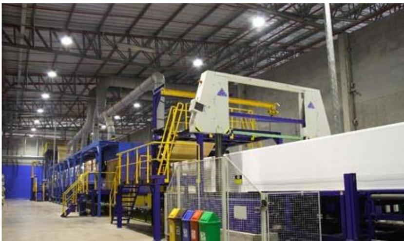
*Figura 5. Esteira de sistema contínuo de Espumação na Indústria.*
