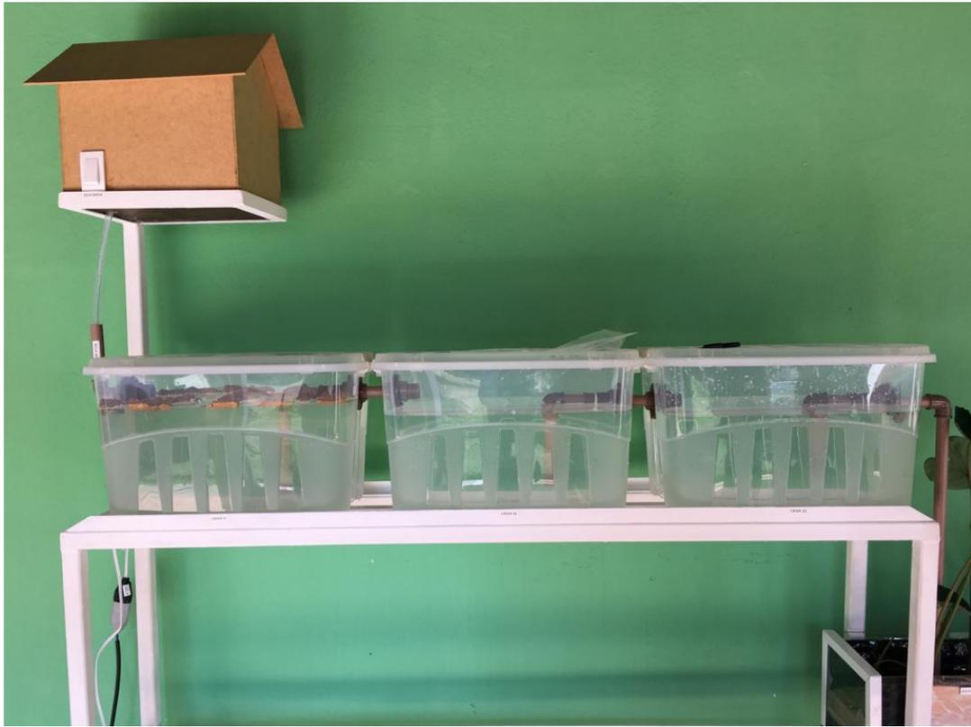
Figura 3: Protótipo do biodigestor abastecido.
