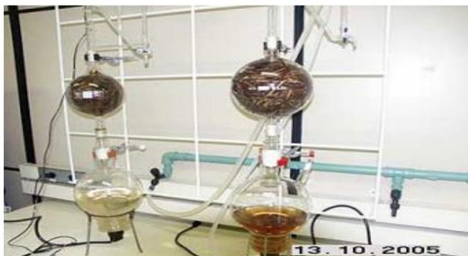
Figura 4 - Unidade de arraste a vapor em escala laboratorial.
