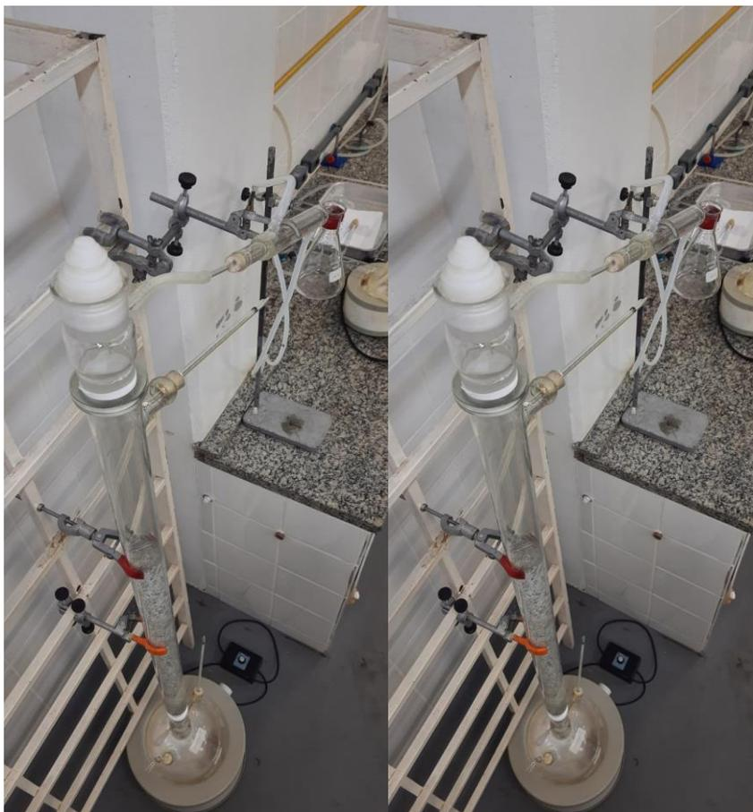
Figura 4-Sistema de destilação montado
