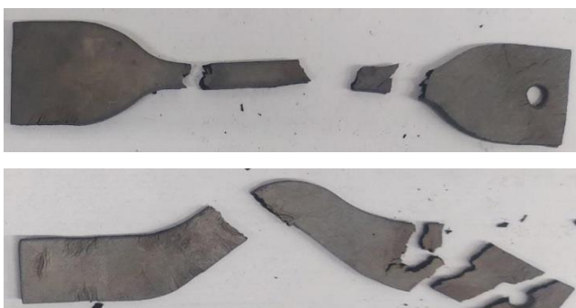
Figura 12 – Corpo de prova envelhecido ensaiado. Ruptura e rasgo respectivamente (Próprios autores).
