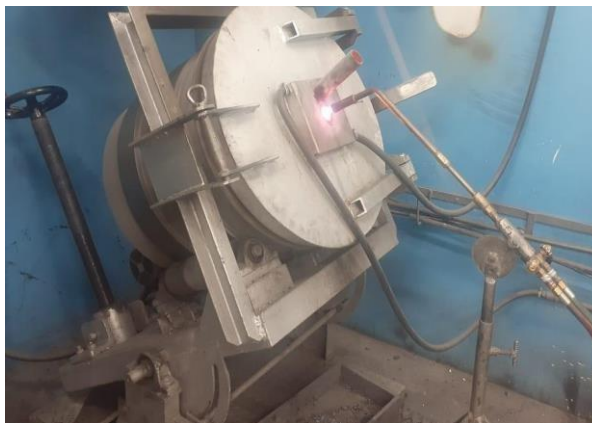
Figura 7 - Ensaio de corrosão em andamento com auxílio de maçarico para aquecimento
