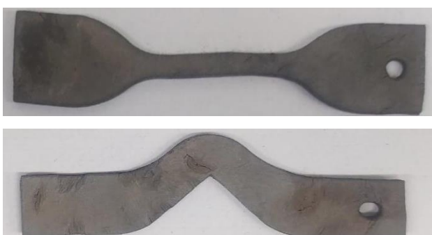
Figura 11 – Corpo de prova envelhecido, ruptura e rasgo respectivamente (Próprios autores).
