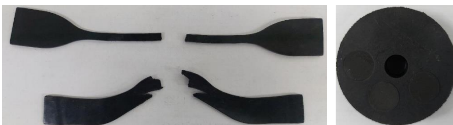
Figura 10 – Corpo de prova ensaiado. Ruptura, rasgo e abrasão respectivamente (Próprios autores).
