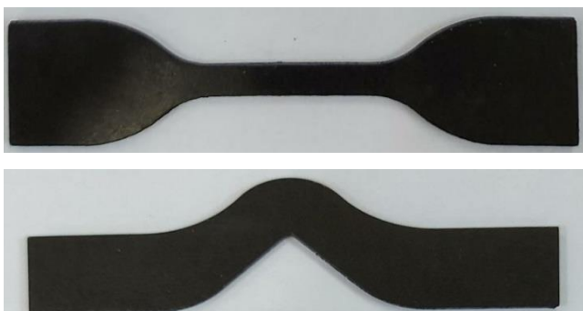
Figura 9 – Corpo de prova de ruptura e rasgo respectivamente (Próprios autores).
