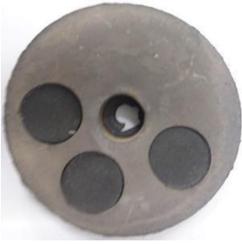
Figura 13 – Corpo de prova envelhecido ensaiado. Abrasão (Próprios autores).
