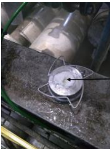
Figura 13: Produto solidificado na retenção de ar comprimido.
