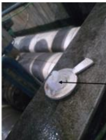
Figura 10: Produto solidificado que foi retirado com a vedação. Fonte: Dos autores,2023.
