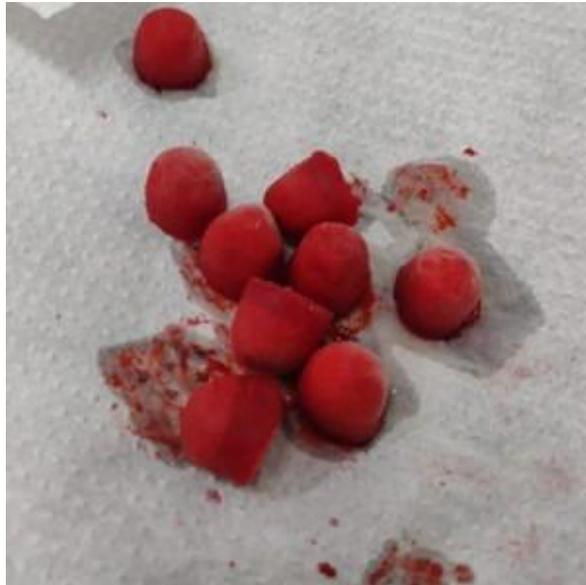
**Figura 9.** Primeiro teste com a formulação completa, com presença de grumos e desmanchando.
