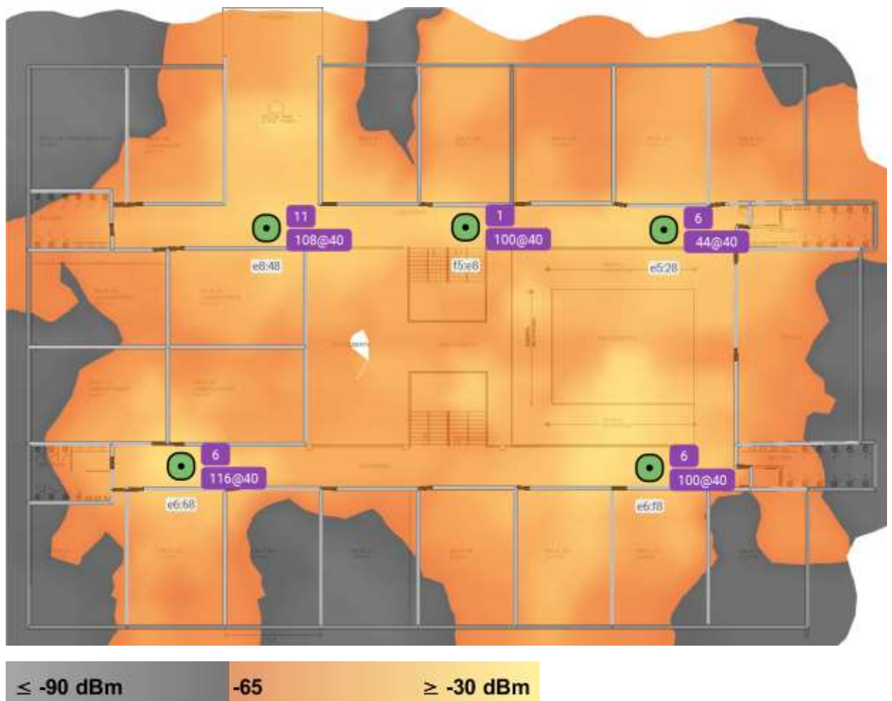
Figura 10: resultado da análise de potência de sinal em 2.4GHz no ambiente estudado
