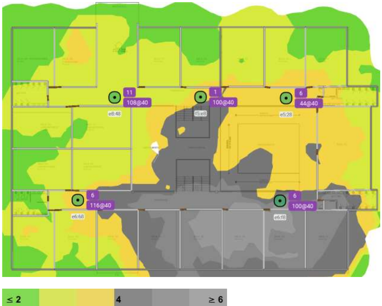
Figura 15: resultado da análise de interferência co-canal em 5GHz no ambiente estudado
