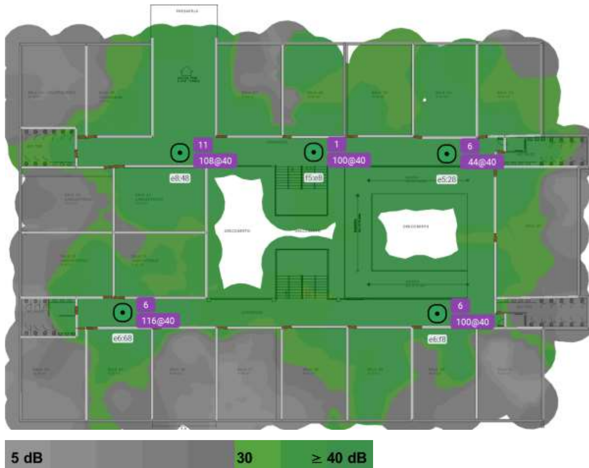
Figura 12: resultado da análise de relação sinal ruído em 2.4GHz no ambiente estudado
