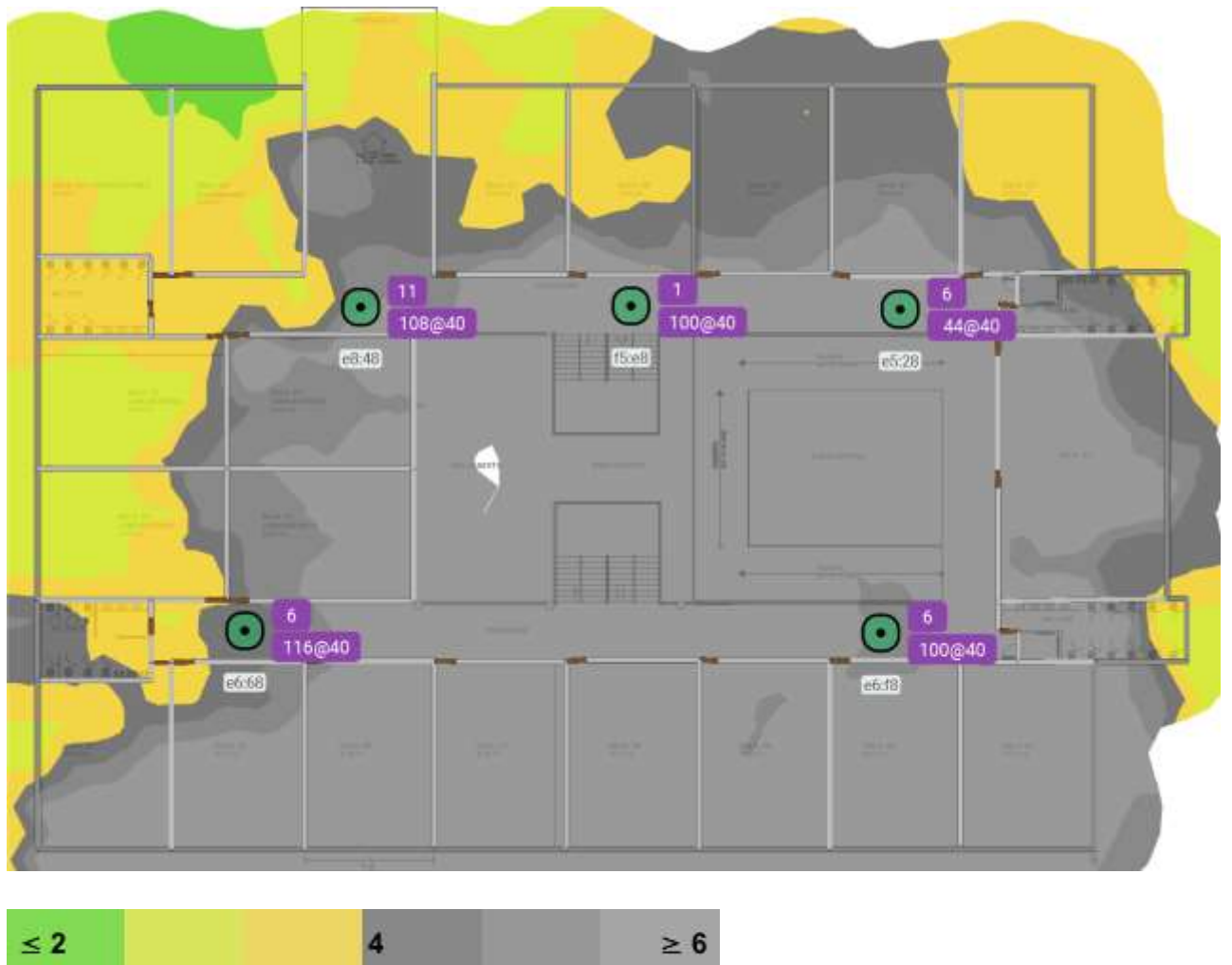
Figura 14: resultado da análise de interferência co-canal em 2.4GHz no ambiente estudado
