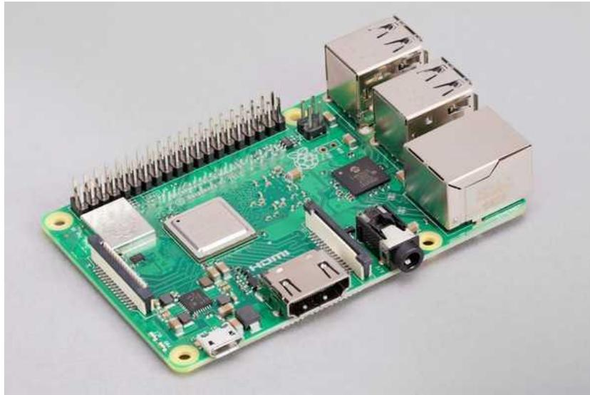
Para Silva (2019), o Raspberry Pi se destaca como uma ferramenta que promove o desenvolvimento do raciocínio lógico, tornando-se uma escolha apropriada para integrar diversos tipos de projetos tecnológicos. Com um grande volume de material de estudo disponível, o dispositivo foi preparado para suportar periféricos comuns, como saídas HDMI, conexão para mouse, teclado e Wi-Fi integrado, eliminando a necessidade de acessórios adicionais para iniciar o desenvolvimento.
