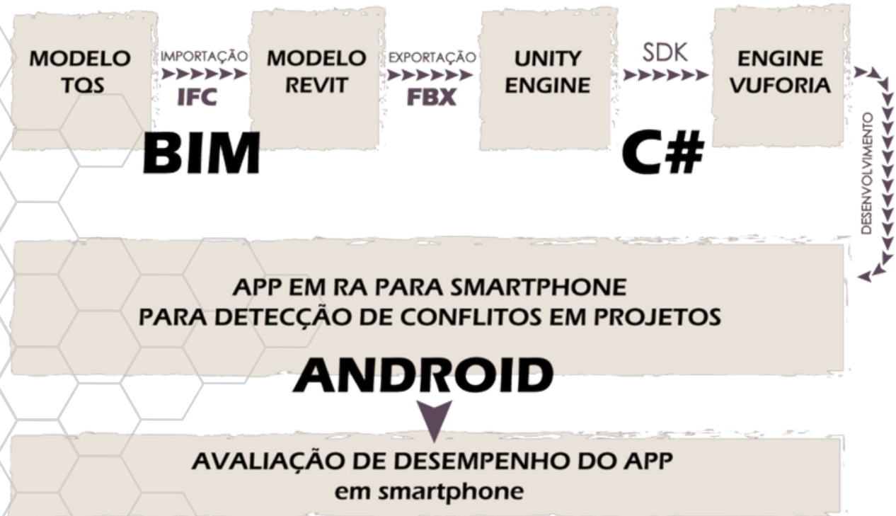
Figura 1: Metodologia de desenvolvimento do aplicativo em RA a partir de modelo 3D em BIM. Fonte: os autores.
